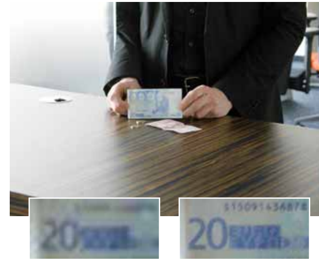
Bild einer Überwachungskamera Großansicht: Vollbild links: Detailsicht des Vollbildes mit PAL Auflösung rechts: Detailsicht des Vollbildes mit einer 3 Megapixelkamera
